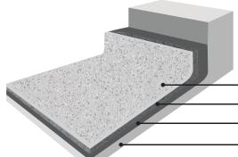
· ISO-101 Topcoat · Colored Quartz · PUR-Guard HD-SLE · Concrete
